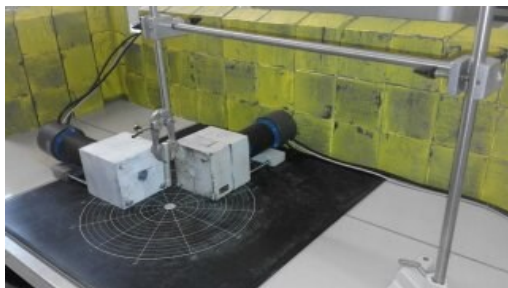
شکل ۵. پیکربندی آزمایش با پنجره ی سربی تحت زاویه 90^\circ .
