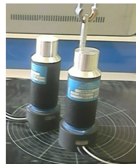
شکل ۴. پیکربندی آزمایش بدون پنجره ی سربی تحت زاویه 270^\circ .
