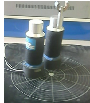
شکل ۲. پیکربندی آزمایش بدون پنجره ی سربی تحت زاویه 90^\circ .
